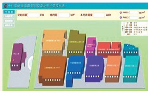
空汙偵測警示 SCADA用電有效管理，效率運用得宜
